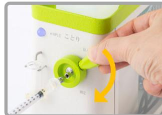
注意 ⚠ 下げる時間が極端に遅いと、配管やポンプが破損する恐れがあります。
